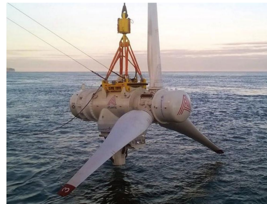
Turbiini. MeyGen-niminen järjestelmä koostuu neljästä 1,5 megawatin turbiinista eli voimalan kokonaiskapasiteetti on 6 megawattia. KUVA: SAE ENERGY
